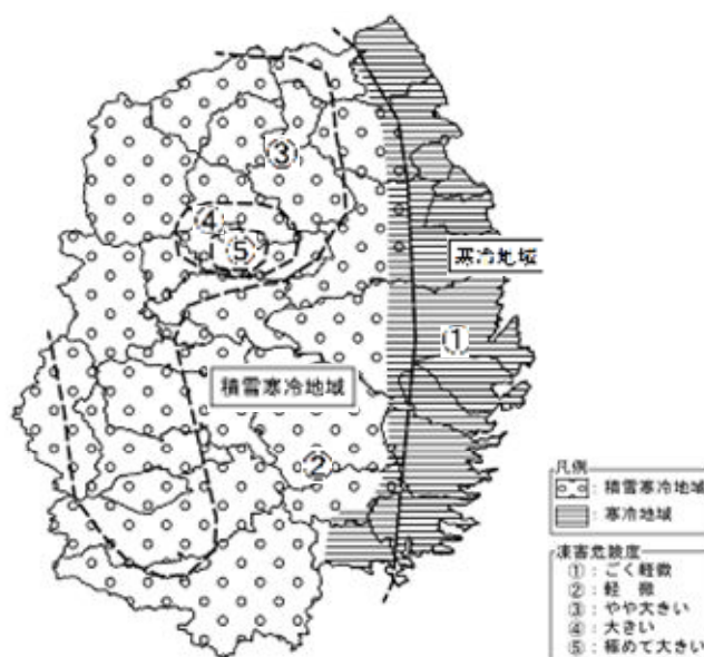
凍害危険度マップより ※コンクリートの凍害危険度算出と水セメント比限界値の提案
